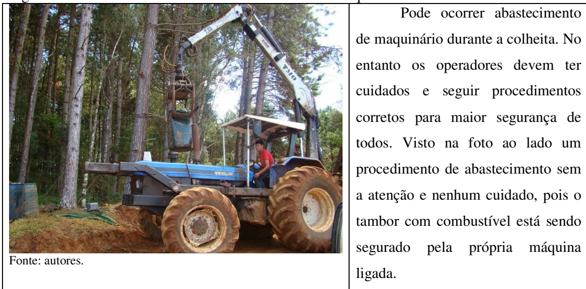
Figura 22: Procedimento incorreto: abastecimento de maquinário
